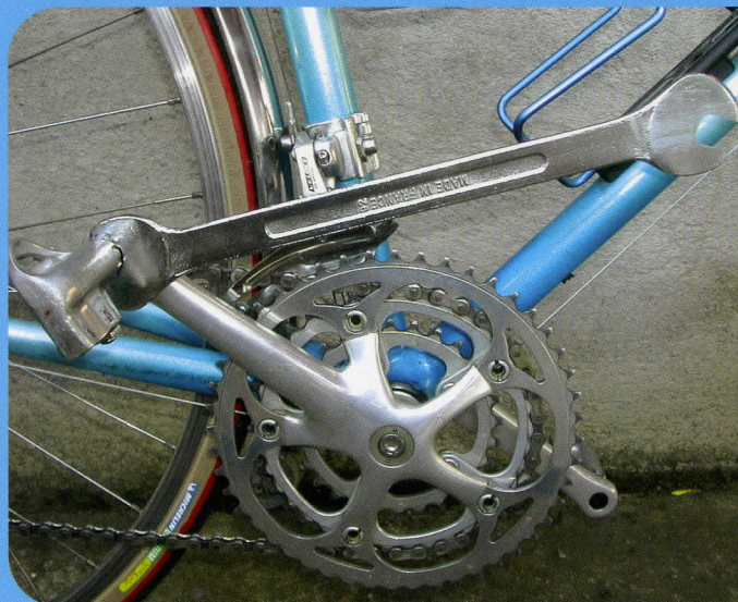
▲ Démontage de la pédale.
